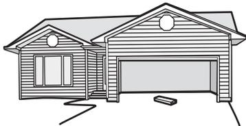
**2** Appuyer sur le bouton-poussoir de la télécommande pour fermer la porte. La porte DOIT remonter quand elle entre en contact avec la planche.
