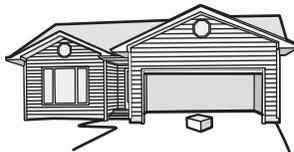
**2** Appuyer sur le bouton-poussoir de la télécommande pour fermer la porte. La porte ne se déplacera pas de plus de 2,5 cm (1 po) et l'éclairage de l'ouvre-porte de garage clignotera 10 fois.
